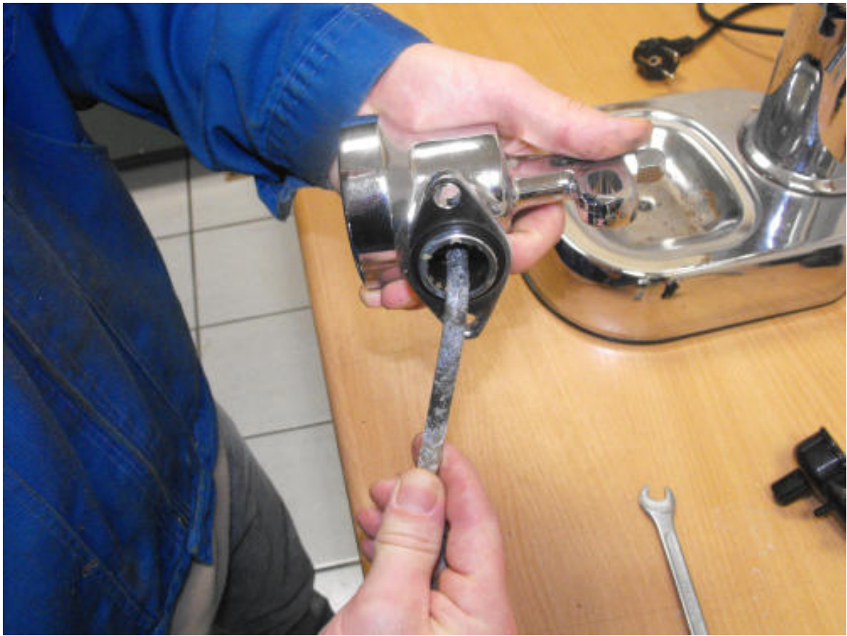
Das Steigrohr herausdrehen
