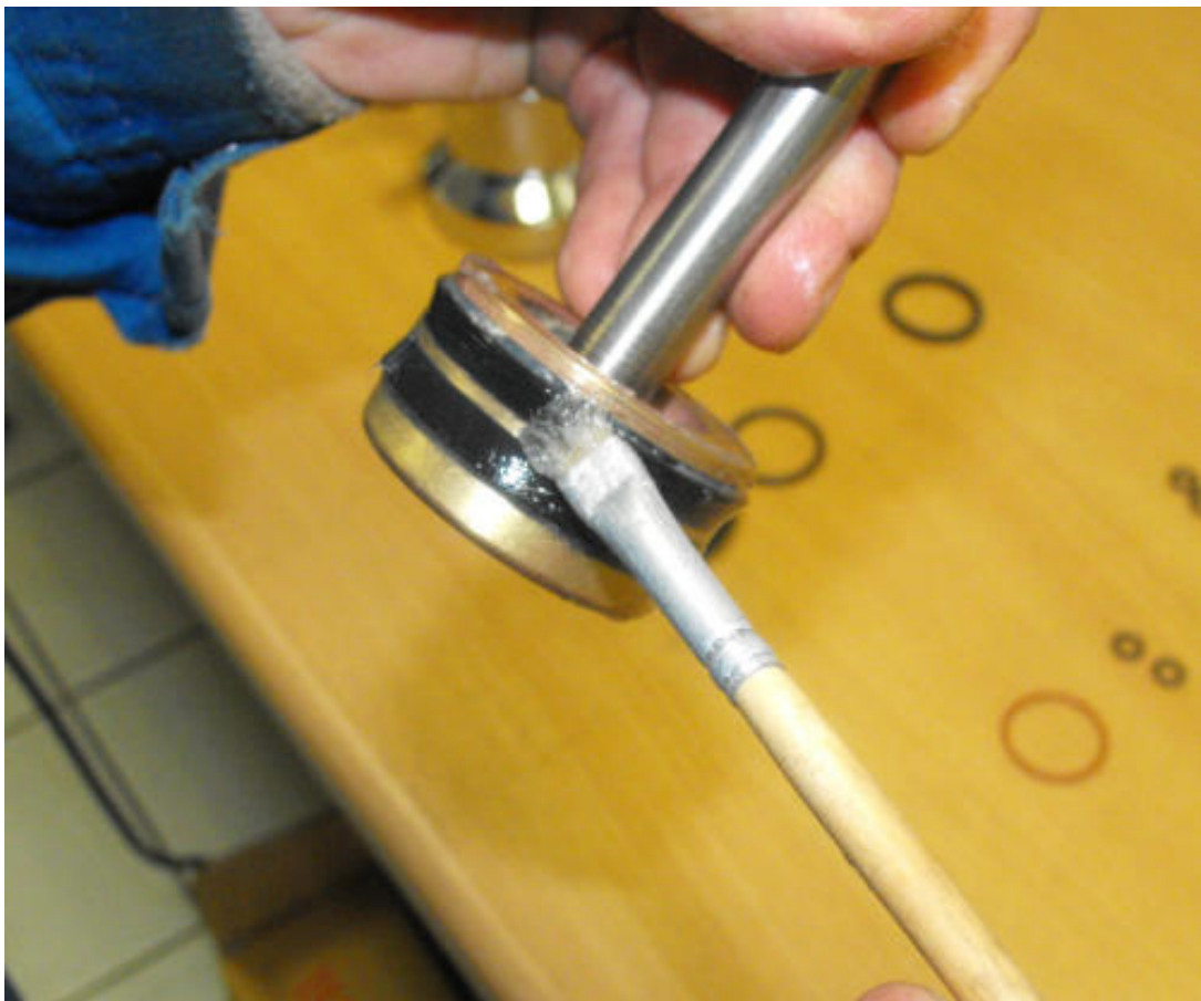
Kolben mit Dichtungen fetten.
