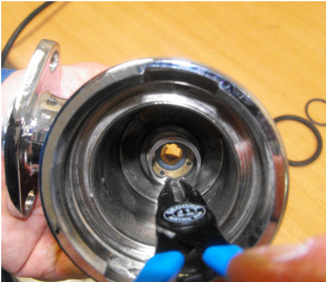
Kolben mit Dichtungen fetten.
