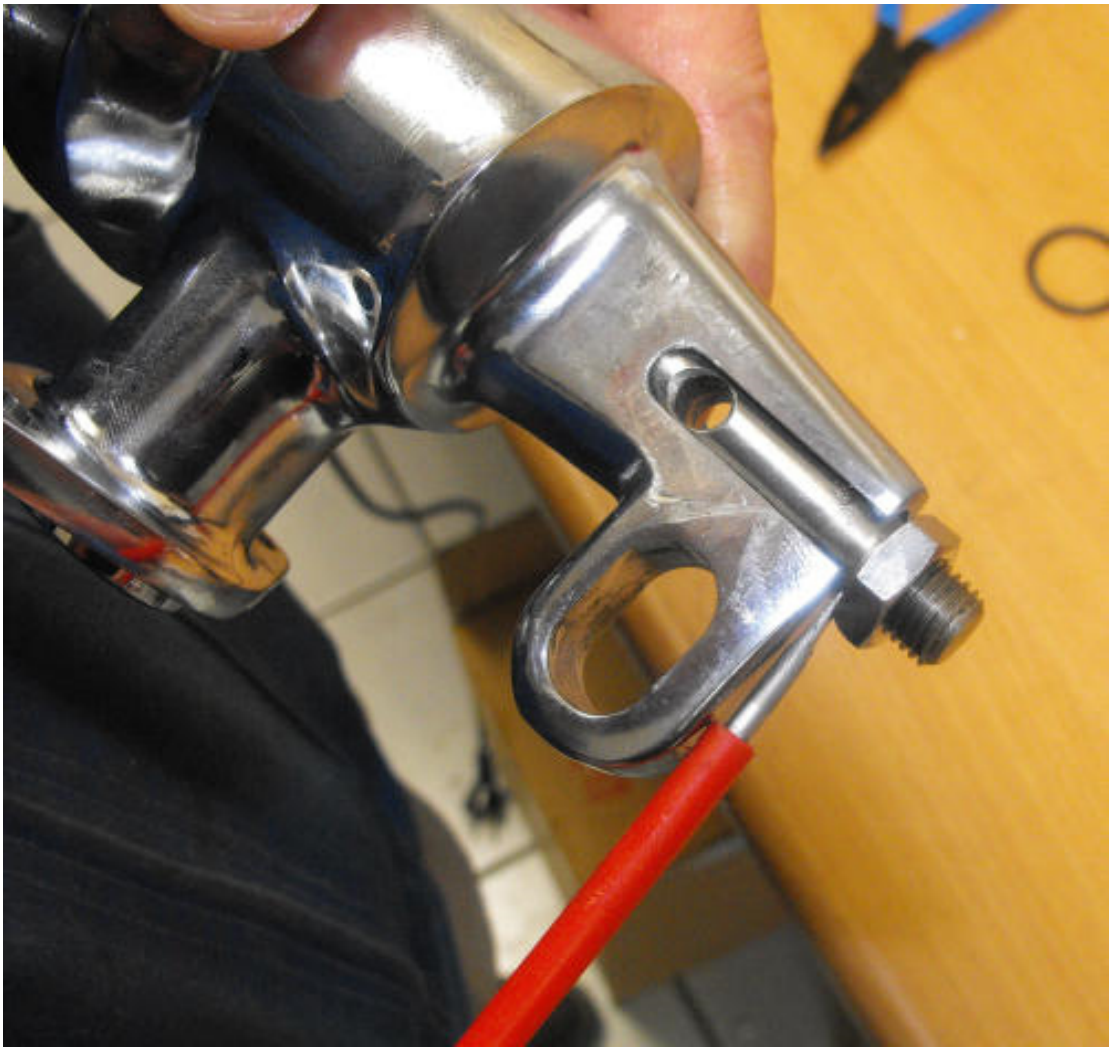
Mit der Hutmutter kontern.
