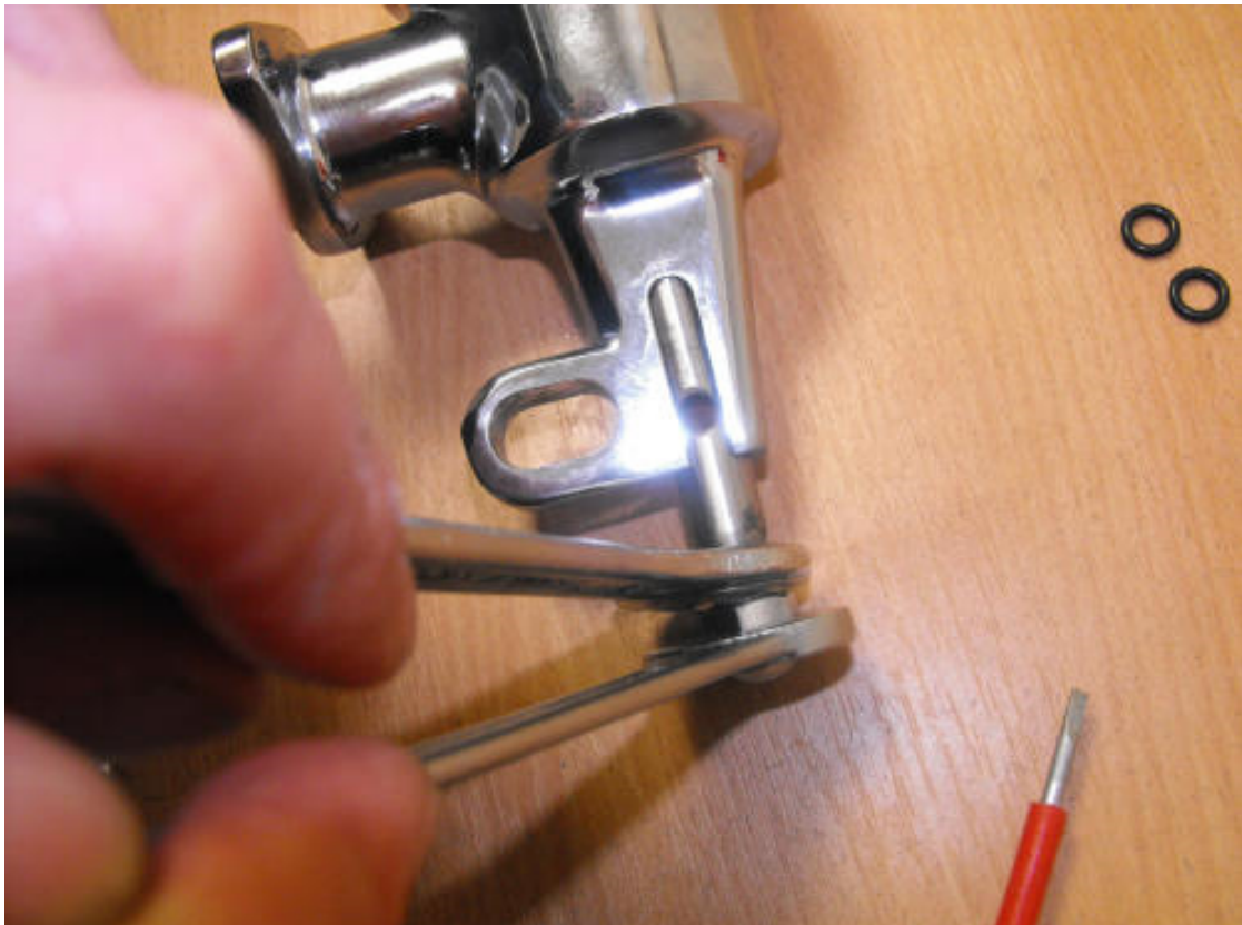
Mit der Hutmutter kontern.
